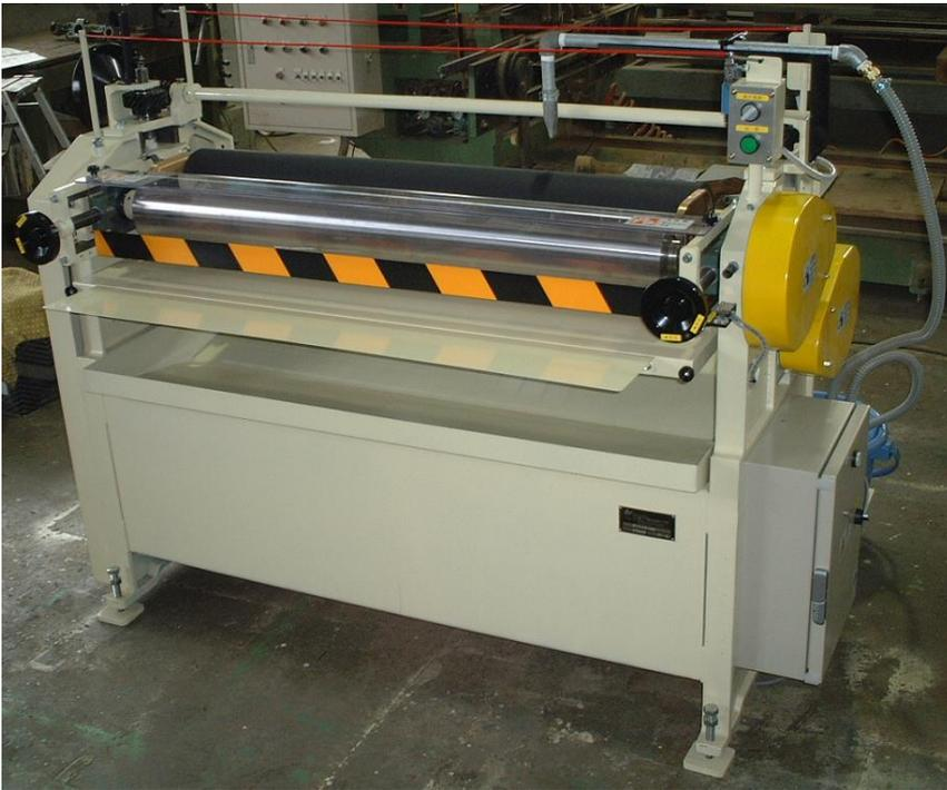
挿入口には中が見易い透明塩ビカバーを、非常停止ロープを前後に採用し安全性をも追求しました。
