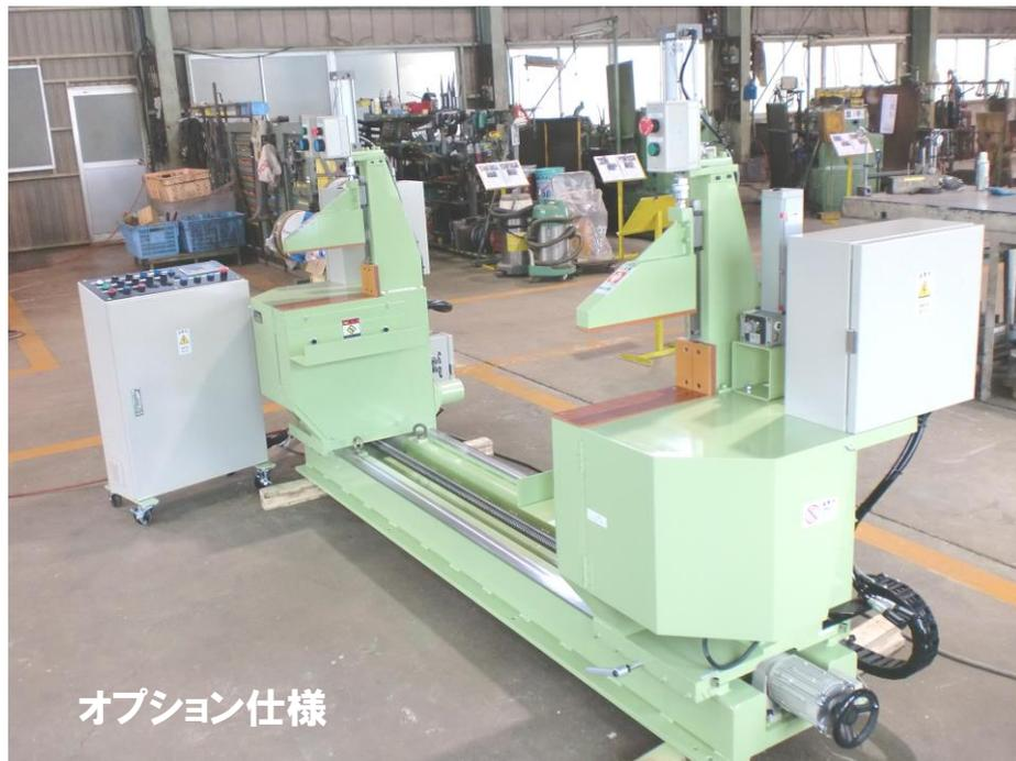
300台を超える実績を誇る両端切断専用のダブルクロスカッターです。クランプ装置、主軸昇降ガイドにはリニアガイドを採用、さらに主軸昇降には10度の角度を付け、ガッチリ抑え、スムーズに少ない抵抗で高精度に綺麗に切断が可能です。ラッピング加工後の定寸切断などに威力を発揮します。
